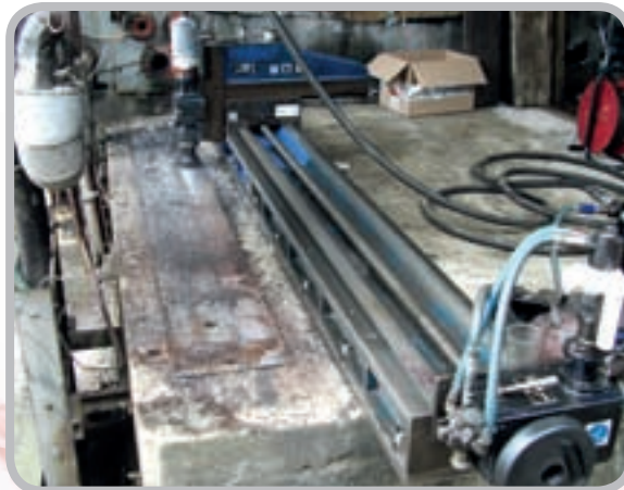
Fraisage de châssis moteur
