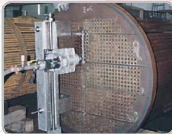
Fraisage de barettes sur faisceau d'échangeur
