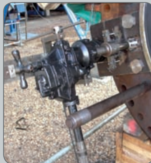
Taraudage M 80 x 300 avec taraud machine
