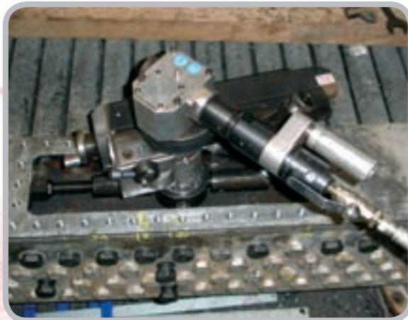
Usinage de bride rectangulaire sur aéro-réfrigérant
