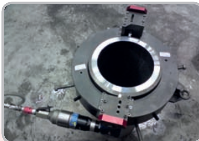
Coupe, chanfreinage de tube et découpe de joint soudé de 2 à 20"
